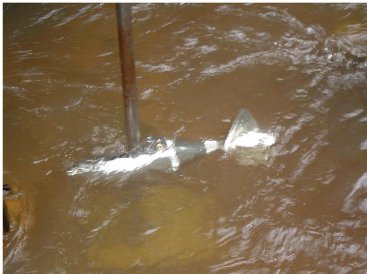
**Figura 10** - Equipamento molinete.
