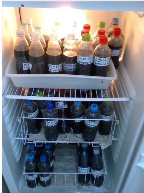
**Figura 30** Reatores armazenados em câmara BOD: Réplicas destrutivas dos tratamentos anaeróbios desenvolvidos nos eudiômetros.
