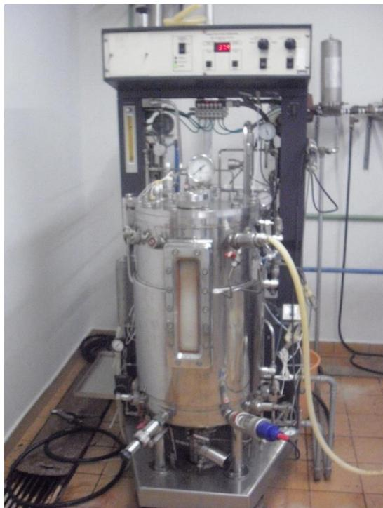
**Figura 7** Biorreator utilizado para cultivo do microrganismo em manipueira e produção do biossurfactante.
