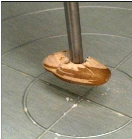
Figura 6 Texturômetro com corpo de prova tipo agulha, utilizado na pesquisa para avaliar a textura dos grãos de feijão.
