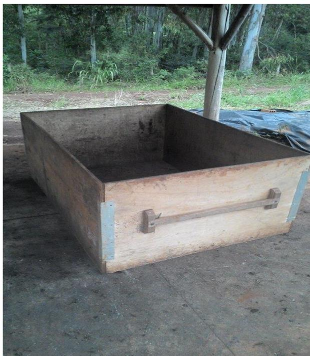
Figura 14 Caixa utilizada para determinação do volume com dimensões conhecidas, largura 1,21 m, altura de 0,80 m, e comprimento de 1,83 m.
