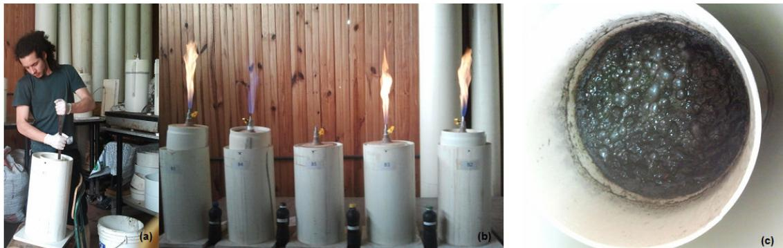
Figura 11 (a) Abastecimento dos biodigestores, (b) queima do biogás e (c) biofertilizante.
