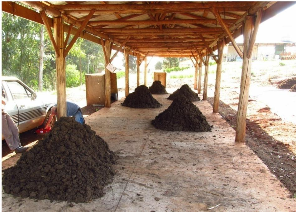
Figura 4 Processo de compostagem em pátio, com piso de concreto e cobertura.
