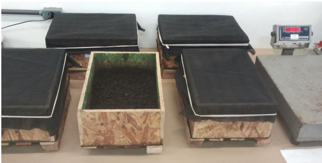
Figura 8 Reatores aeróbios horizontais empregados para o ensaio de vermicompostagem.
