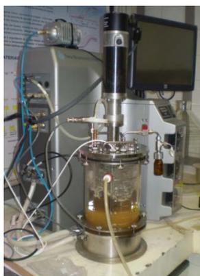
Figura 20 Biorreator piloto utilizado no processo de produção do biossurfactante.
