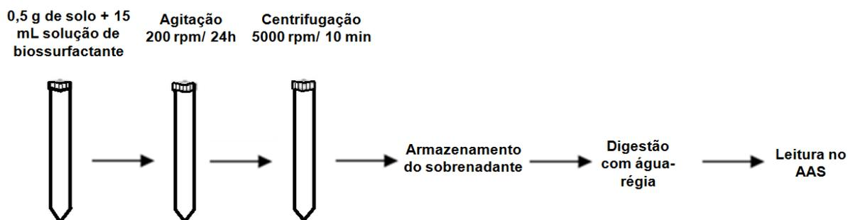
Figura 32 Esquema representativo das etapas realizadas no teste de lavagem do solo – Planejamento experimental nº II.
