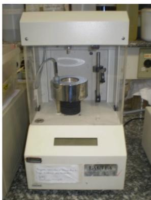
Figura 21 Tensiômetro para determinação da tensão superficial dos extratos recolhidos ao longo do processo de produção via biotecnológica.
