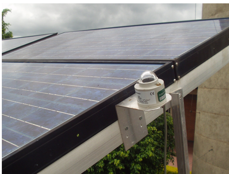
Figura 13 - Piranômetro no plano dos painéis.
