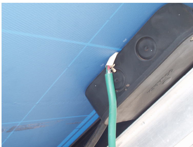
Figura 19 - Localização de instalação do termopar.
