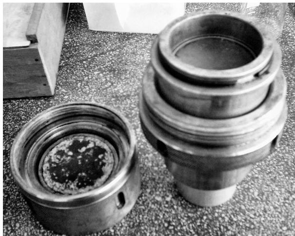
**Figura 11** - Conjunto mecânico de compressão.
