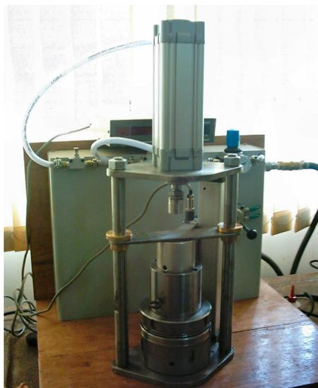
**Figura 10** - Oedômetro desenvolvido por WEISS (2005).
