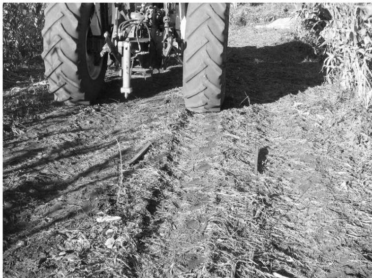
**Figura 24** - Momento de simulação da compactação causada pelo tráfego.
