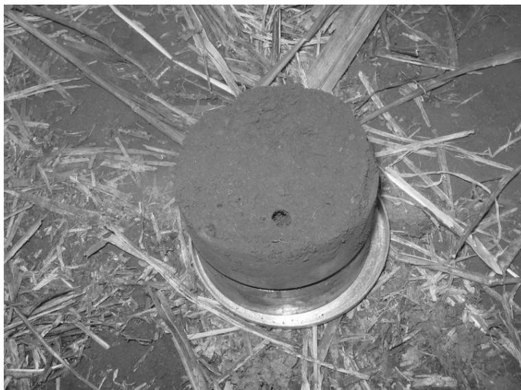
**Figura 22** - Amostra indeformada do solo.
