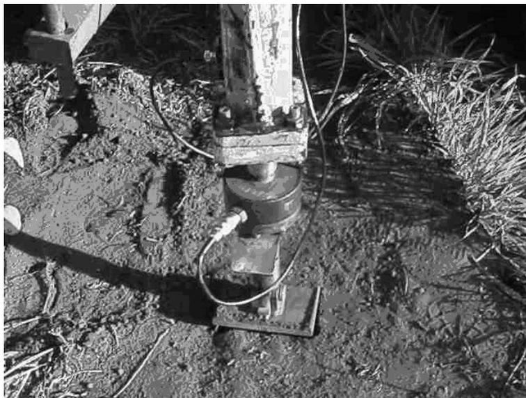
**Figura 7 -** Penetrômetro de placa desenvolvido por BREDA (2003).
