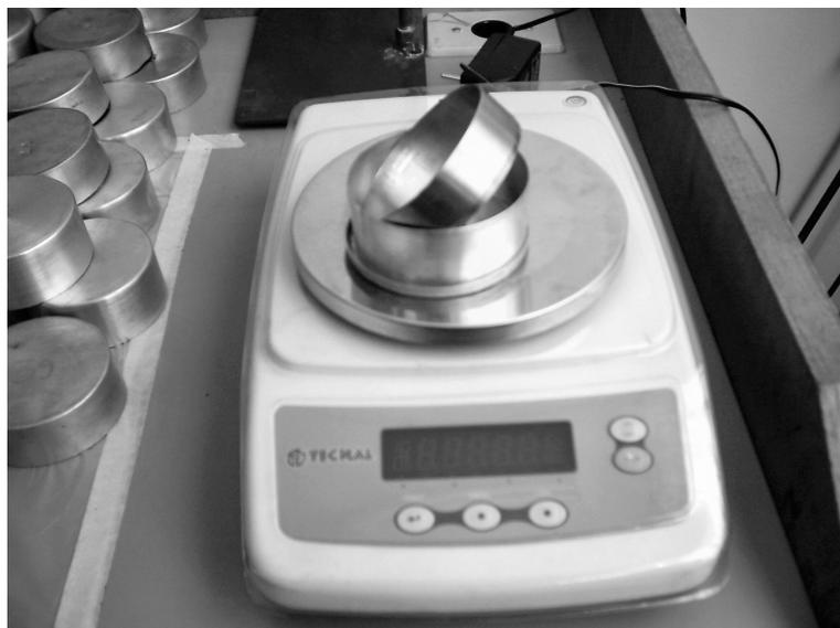
**Figura 23** - Cápsula de metal, anel volumétrico e balança de precisão.
