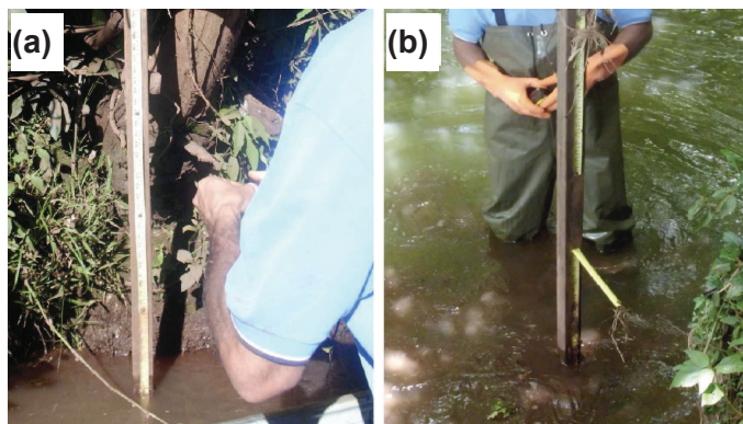
Figura 4 Régua linimétrica em ponto com acesso de barco (a) e com acesso sem barco (b).
