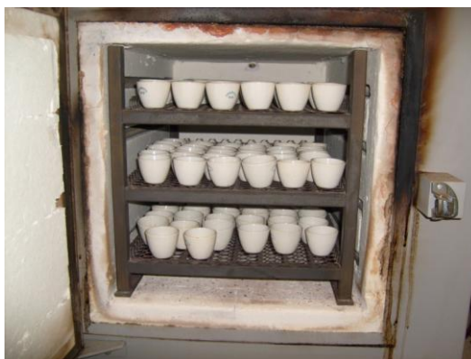
Figura 5 Mufla (Marca Marconi, modelo MA 385/80) com os cadinhos na determinação do carbono.
