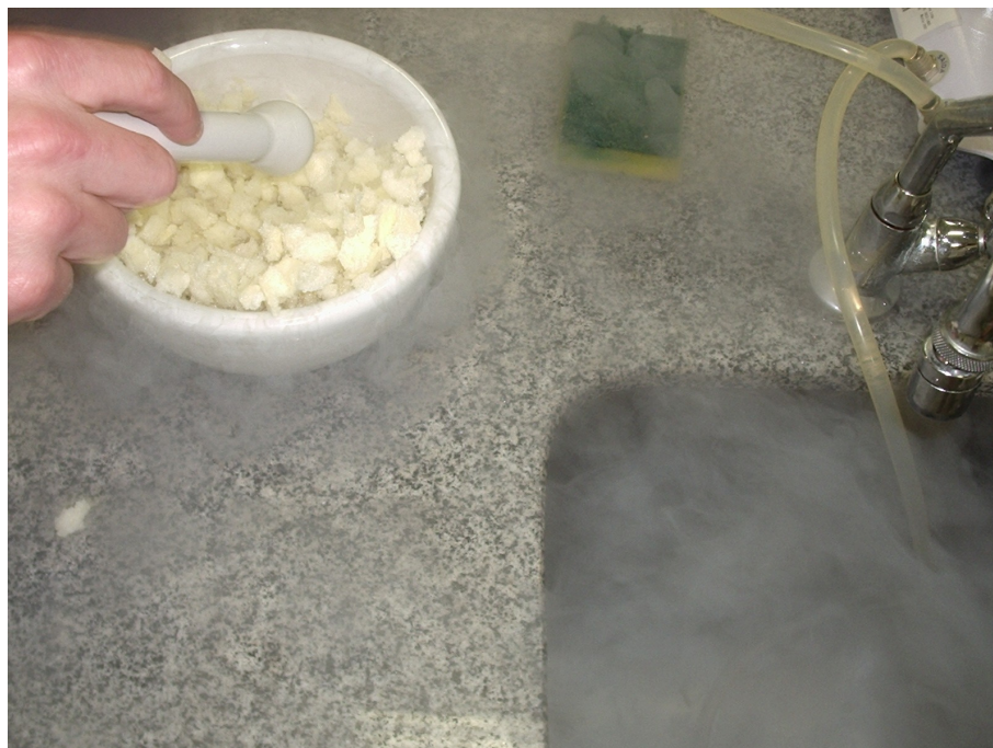
Figura 11 - Cubos de material em almofariz com N 2 líquido.
