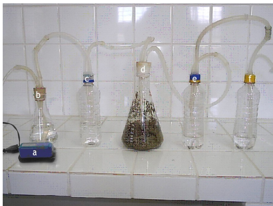
Figura 7 - Foto do respirômetro: a, aerador. Seqüência dos frascos b, c, d, e, f.
