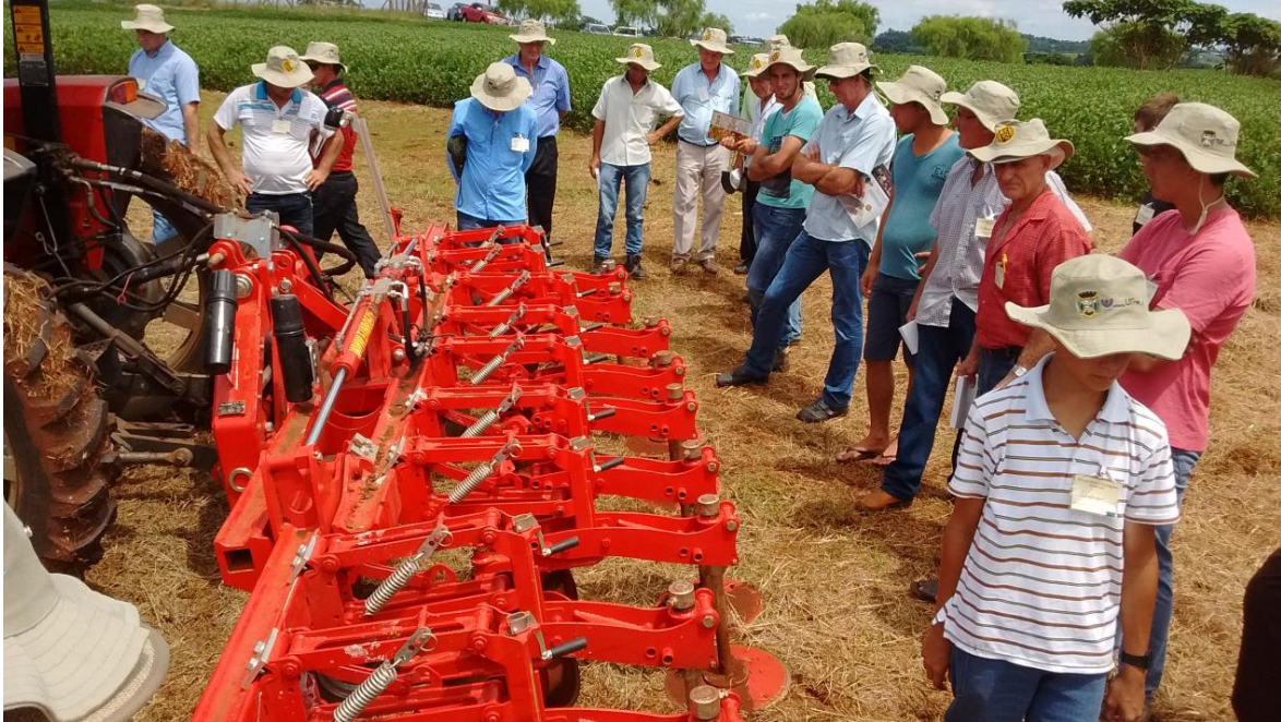
Fotografia 6 – Cultivador mecânico computadorizado, guiado por câmera de alta definição, destinado ao controle de ervas daninhas em área plantada, observado por produtores em ‘dia de campo’
