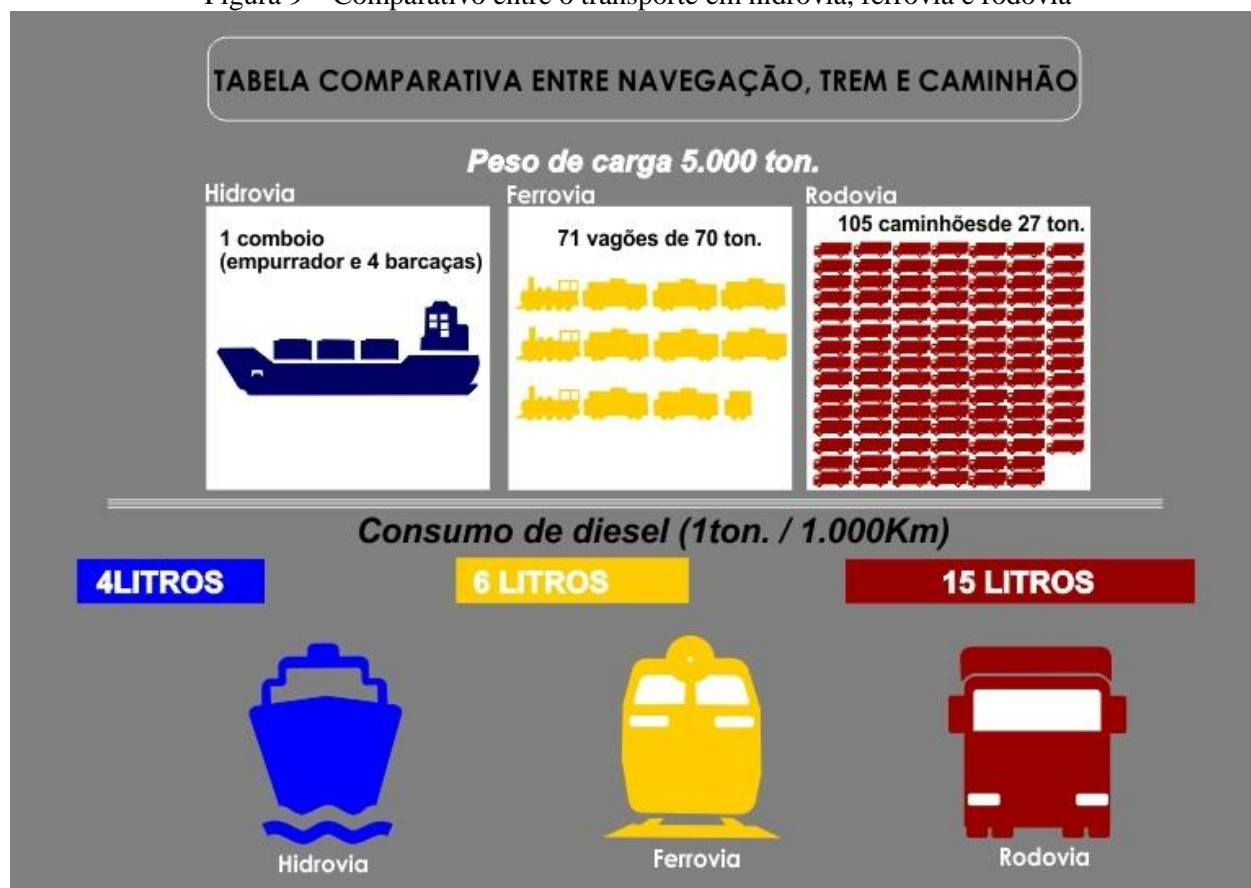
Figura 9 – Comparativo entre o transporte em hidrovia, ferrovia e rodovia
