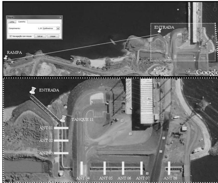
**Fig. 2.** Distribuição das antenas ao logo da escada para peixes da UHE Engenheiro Sergio Motta. Localização do tanque 11.
