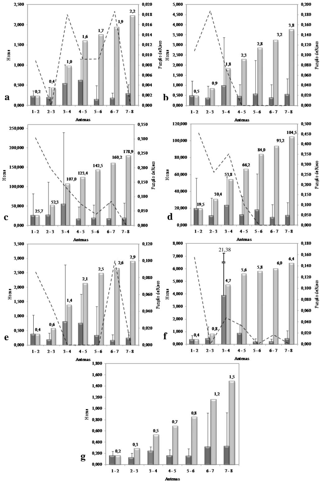
**Fig. 7.** Função de Risco (linha tracejada), tempo médio de deslocamento (horas)  $\pm$  desvio padrão (barras negras), tempo médio acumulado de deslocamento (horas) (barras cinza), entre as antenas da escada para peixes. Figura a – *Piaractus mesopotamicus* (rampa), b – *Piaractus mesopotamicus* (tanque 11), c – *Rhinelepis aspera* (rampa), d – *Rhinelepis aspera* (tanque 11), e – *Brycon orbignyianus* (rampa), f – *Prochilodus lineatus* (tanque 11), g – *Prochilodus lineatus* (rampa).
