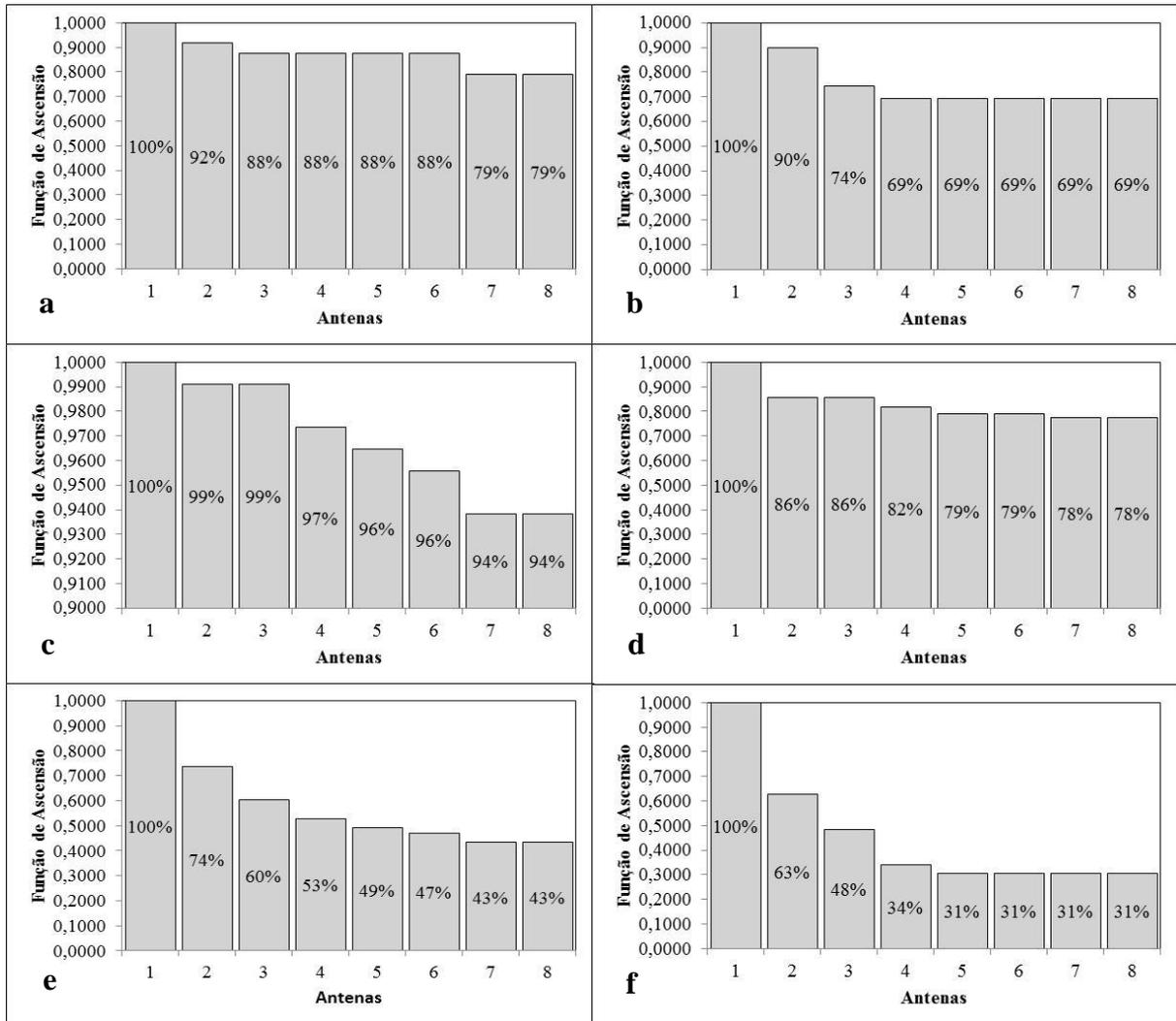
**Fig. 6.** Função de Ascensão representada no ponto médio entre a localização das antenas da escada para peixes. Figura a – *Brycon orbignyanus* (rampa), b – *Prochilodus lineatus* (tanque 11), c – *Piaractus mesopotamicus* (rampa), d – *Piaractus mesopotamicus* (tanque 11), e – *Rhinelepis aspera* (rampa) e f – *Rhinelepis aspera* (tanque 11).
