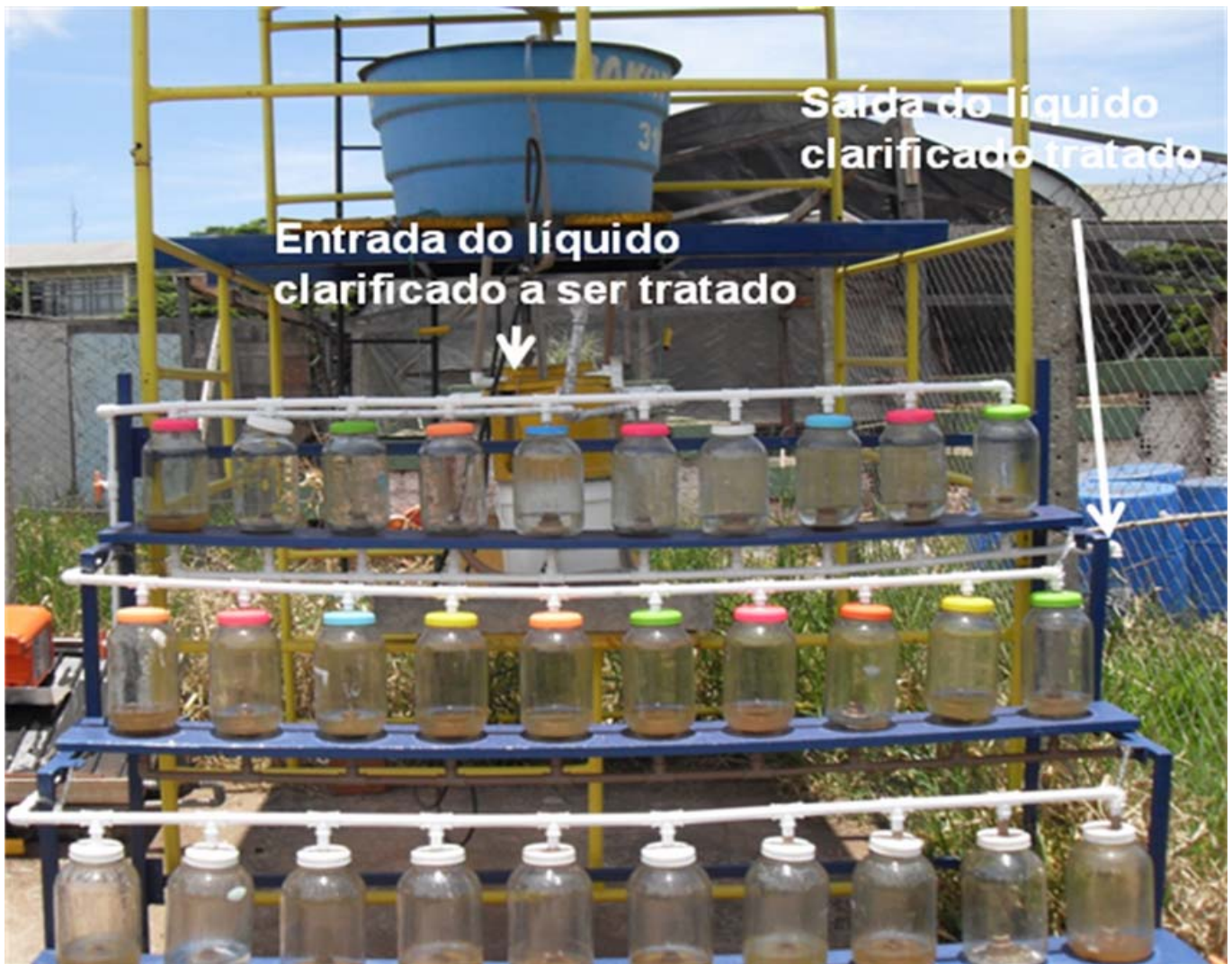
Figura IV.30 Sistema de desinfecção de organismos patogênicos por meio de radiação solar.
