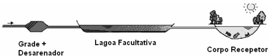
Figura II.4 Esquema de um sistema de tratamento com lagoas facultativas. Fonte: Matos (2005).
