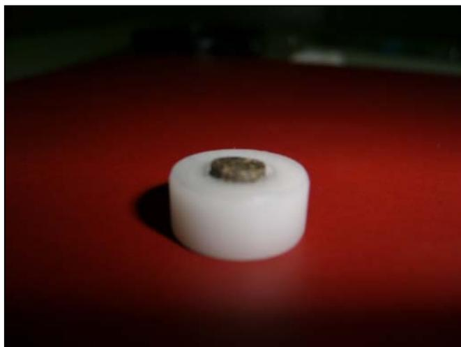
**Figura 4.3** – Pastilha de amostra no porta-amostra de teflon.
