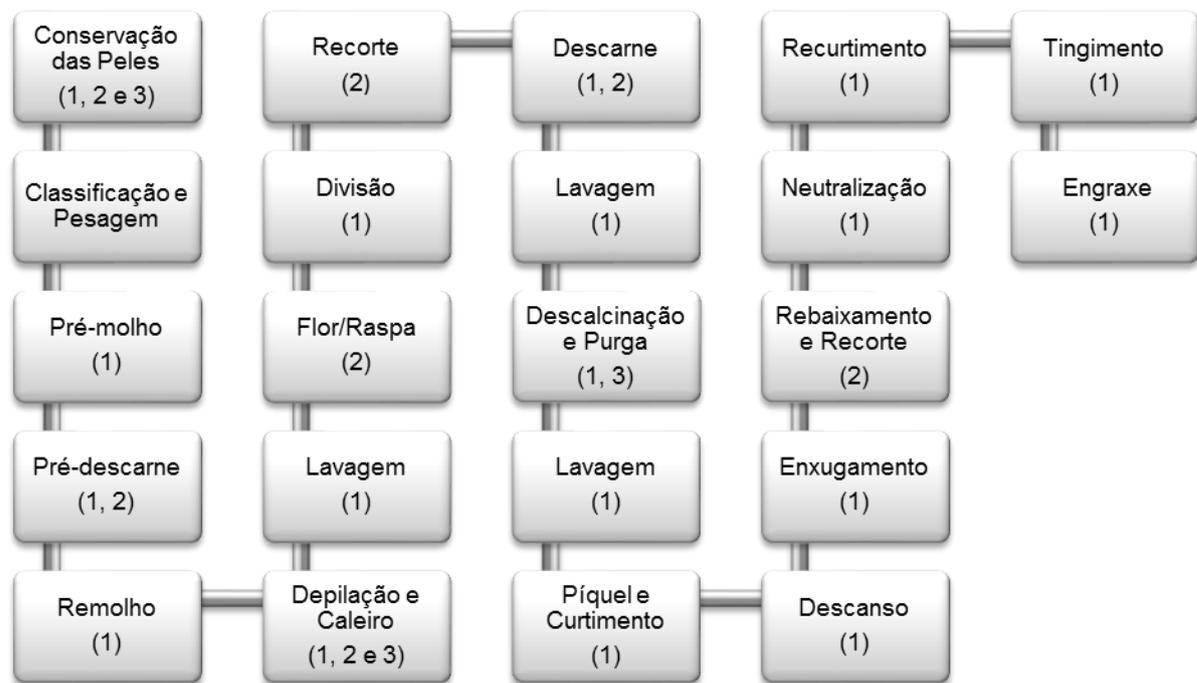
**Figura 1.** Fluxograma geral do processamento do couro, onde cada etapa seguida do número 1 indica geração de resíduo líquido, número 2 resíduo sólido, e número 3 resíduo gasoso. Adaptado de Pacheco (2005).
