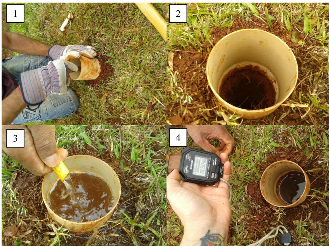
**Figura 16.** Ensaio de infiltração *in situ*
