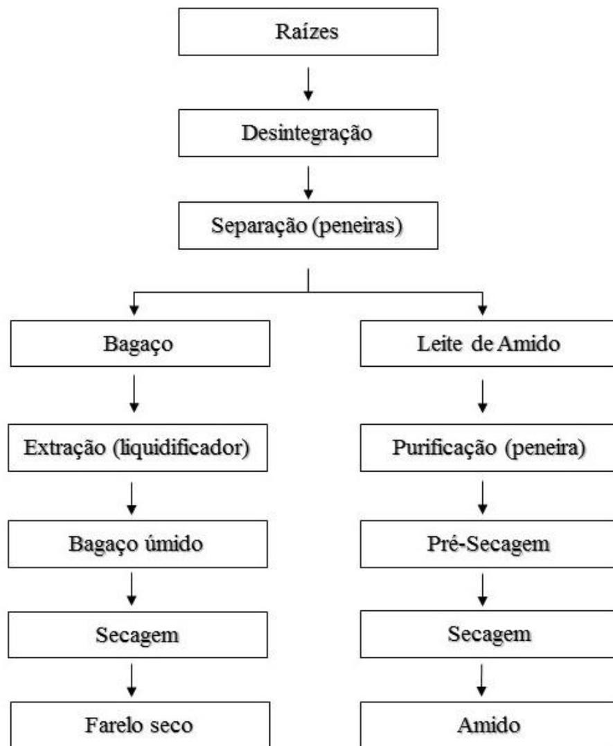
Figura 1. Fluxograma do processamento para obtenção do amido.
