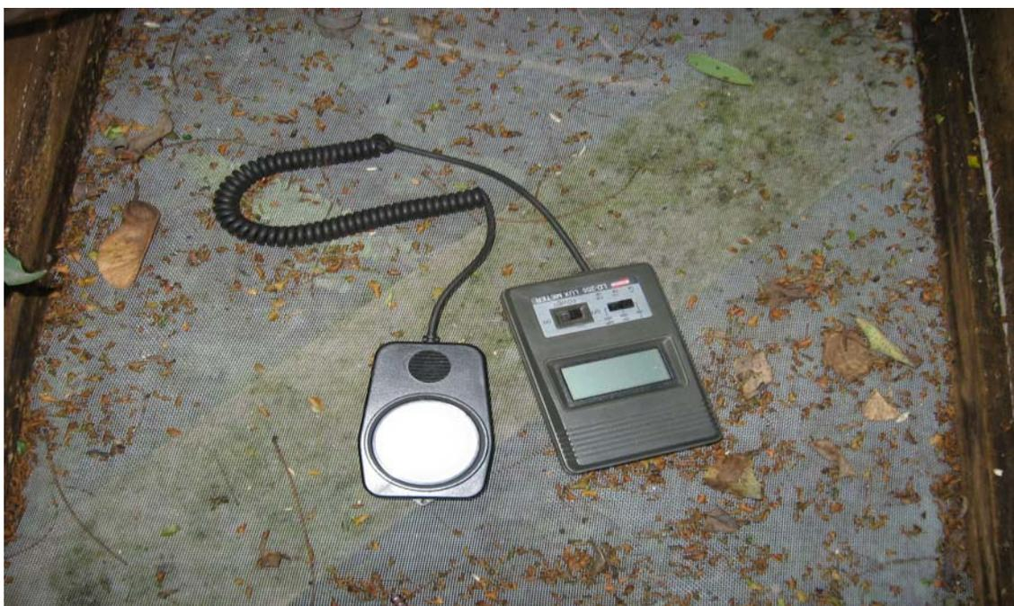
**Apêndice 2.** Luxímetro utilizado no registro coleta de intensidades luminosas, na área de Captação 1 do SAAE
