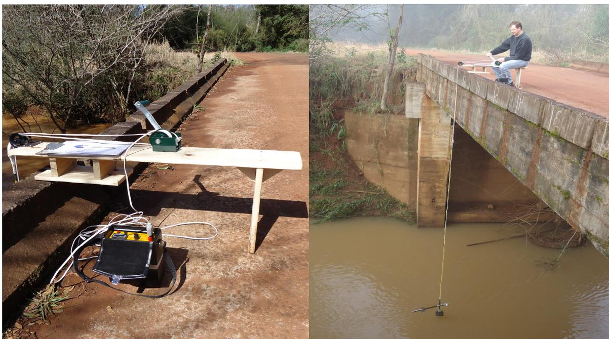
Figura 13 – Guincho utilizado para auxiliar as medidas de velocidade de fluxo com molinete fluviométrico de cima da ponte.
