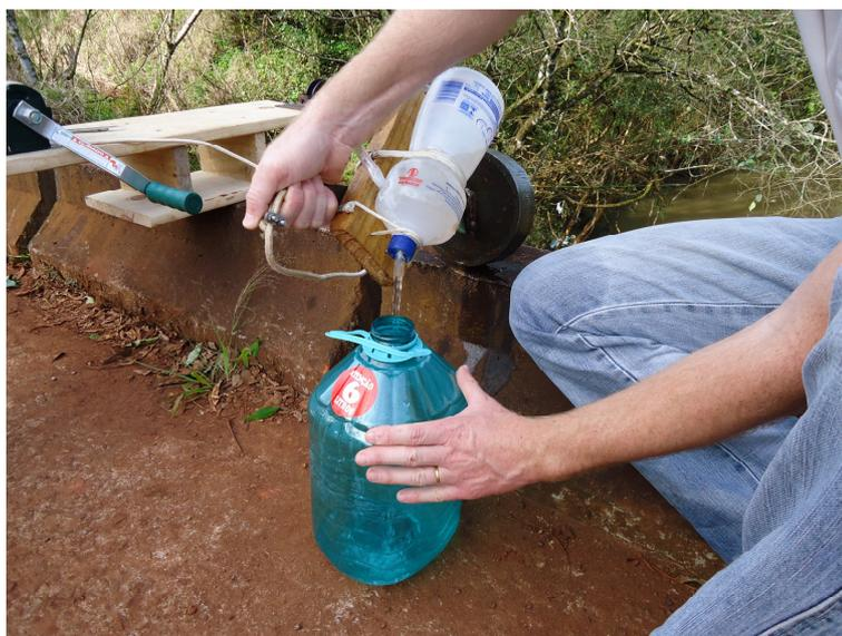
Figura 18 – Composição das amostragens de água das verticais de coleta no canal.
