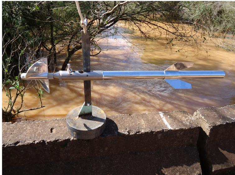
Figura 9 – Molinete fluviométrico universal de Newton utilizado nas medidas de velocidade de fluxo.
