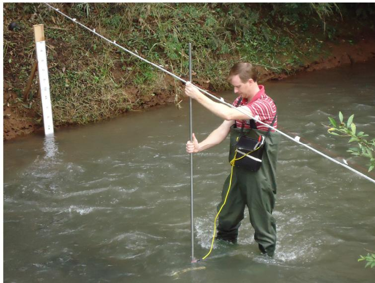
Figura 11 – Medida de velocidade fluxo com molinete fluviométrico com haste a vau.
