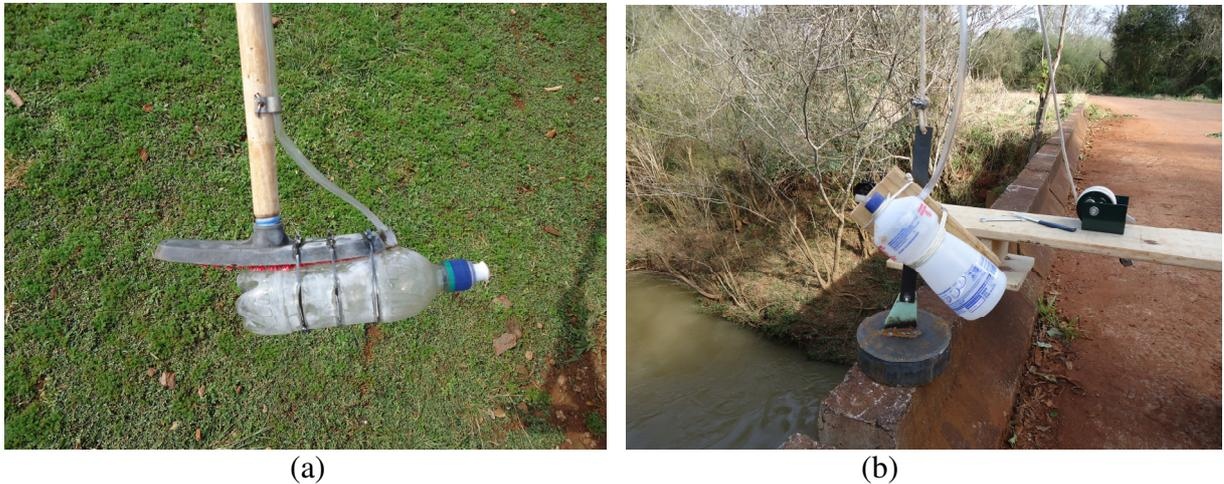
Figura 16 – Amostragens de sólidos em suspensão. (a) Coletor de garrafa plástica manual. (b) Coletor de garrafa plástica adaptado a um guincho.
