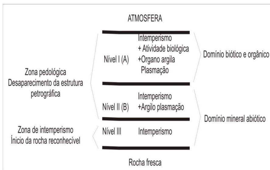
Figura 1 – Níveis de intemperismo, considerando um solo bem desenvolvido, a partir da rocha (PEDRO, 1997).
