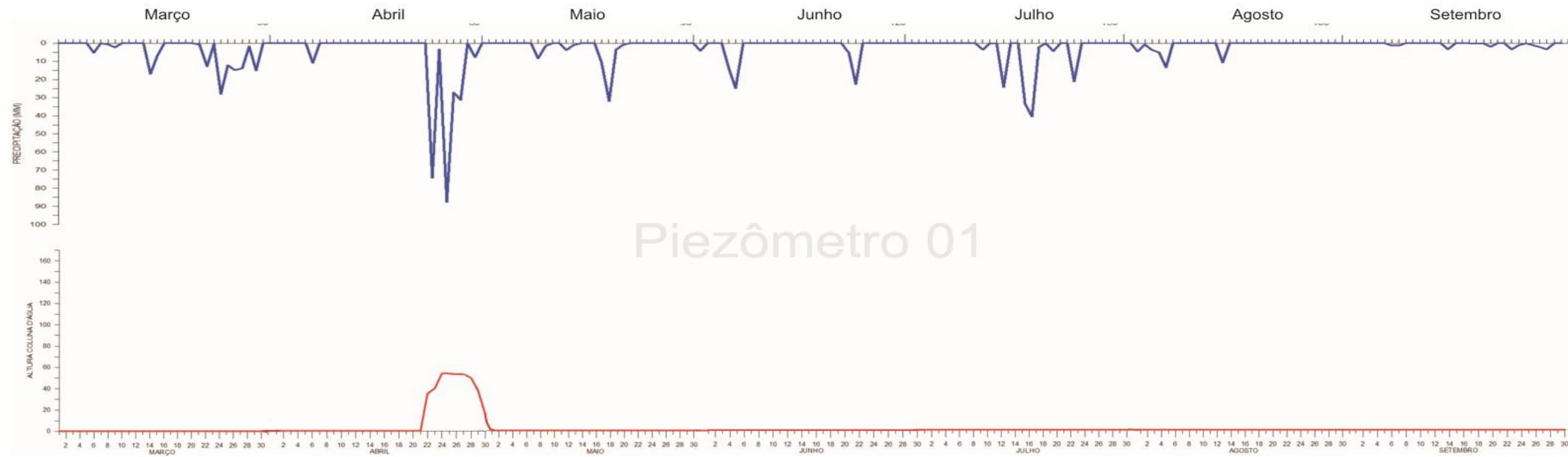
Figura 19 – Registros pluviométricos e altura piezométrica (piezômetro 1) de março a setembro de 2010.
