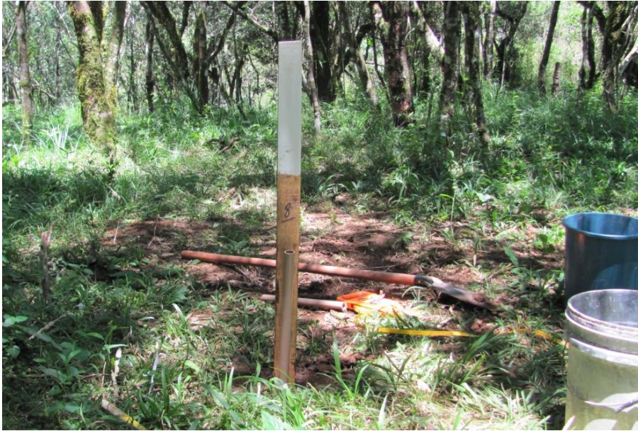
Figura 9 - Piezômetro utilizado na pesquisa.
