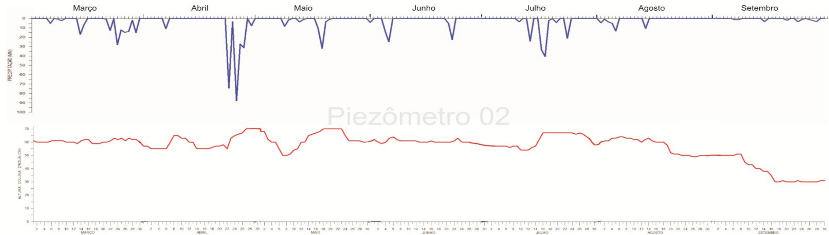
Figura 20 – Registros pluviométricos e altura piezométrica (piezômetro 2) de março a setembro de 2010.
