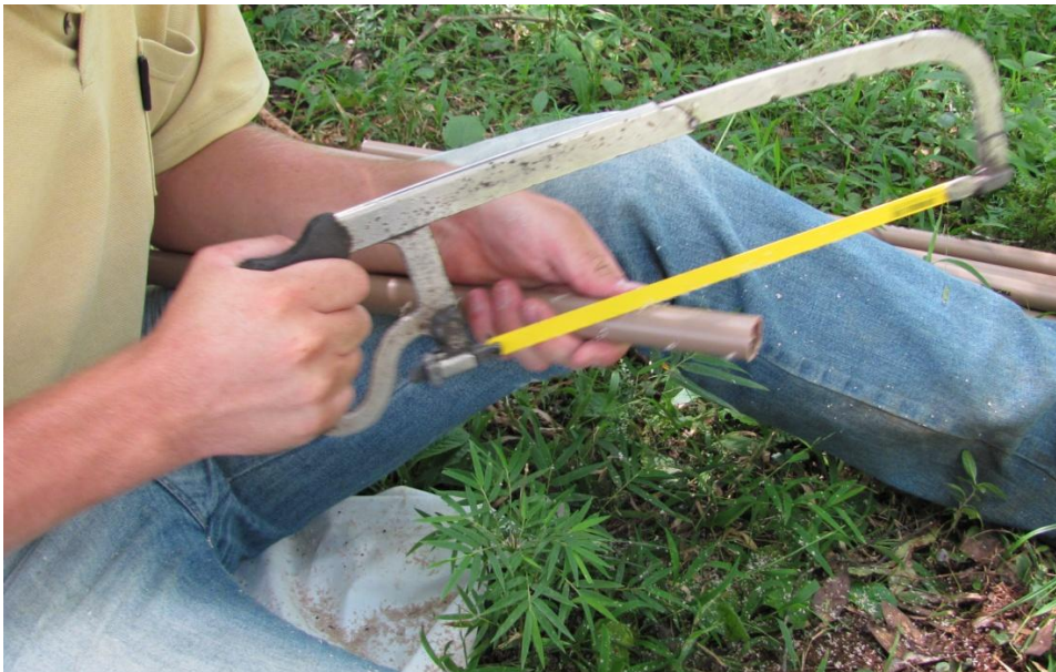
Figura 8 - Confeção dos piezômetros.
