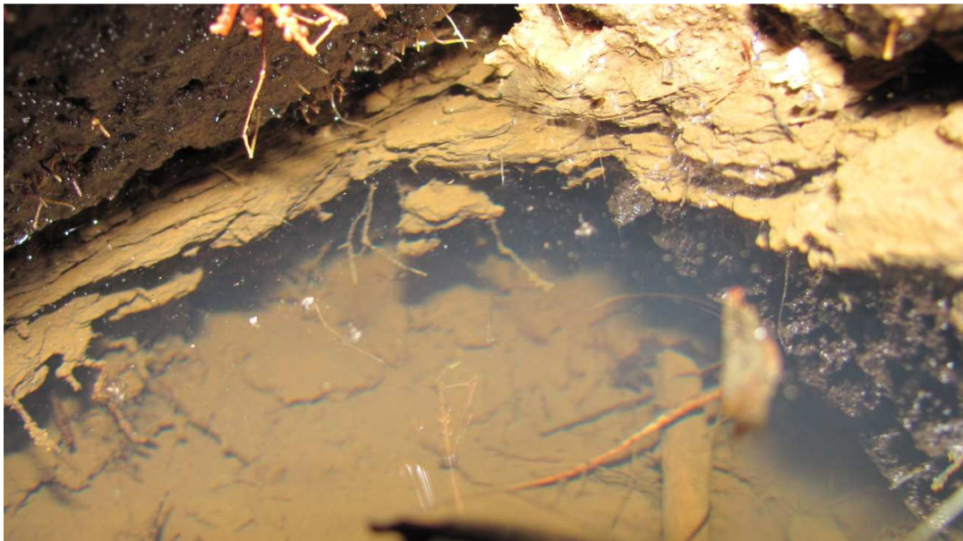
Figura 21 - Material com estrutura lamelar encontrado no contato com a rocha. Foto: autor
