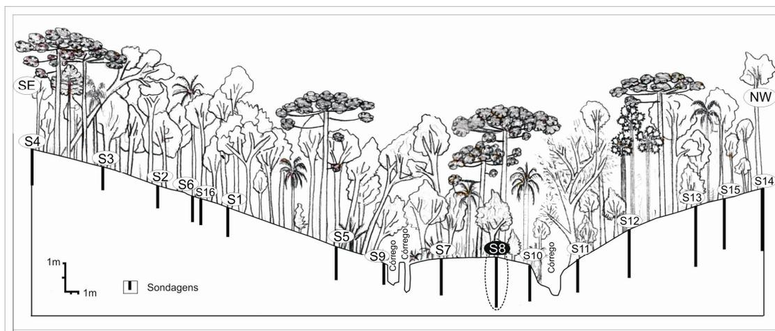
Figura 4. Perfil topográfico transversal à porção central da cabeceira de drenagem estudada, mostrando os locais de sondagens (S1...S16). Linha descontinua indica o local de coleta de amostras para granulometria e determinação de teores de Matéria Orgânica (MO) e Carbono (C).
