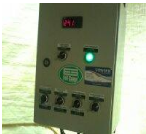
Foto 4: Painel de controle automático da máquina de queima do pellets. Fonte: Pesquisa de campo na propriedade de H. H., Outubro/2013.
