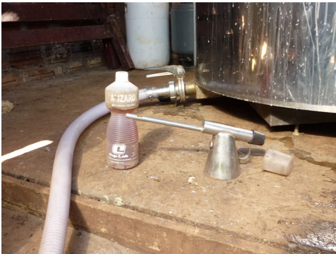
IMAGEM 04 - Pistola e Alizarol para análise de acidez do leite. Nesta foto tem-se à esquerda um recipiente com Alizarol, ao meio a pistola para a coleta e medida de volume de leite e Alizarol a ser misturado no recipiente que está à direita.
