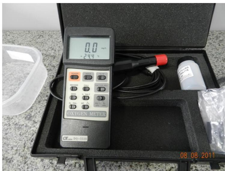
FIGURA 14- Oxímetro Oxygen Meter® utilizado nas medições de Oxigênio dissolvido e temperatura
