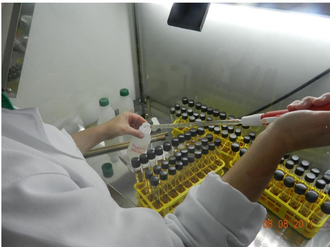
FIGURA 15- Técnica de diluição em tubos, série de 10 tubos, de NMP para coliformes em água.
