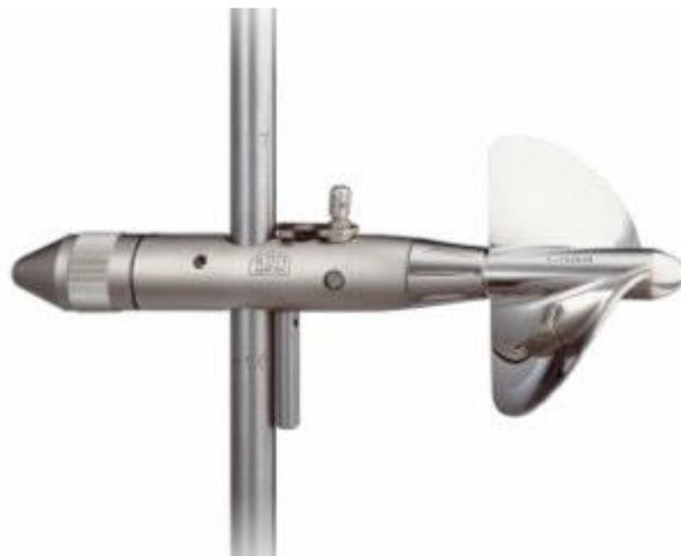
FIGURA 26- Molinete Fluviométrico Universal de Newton.
