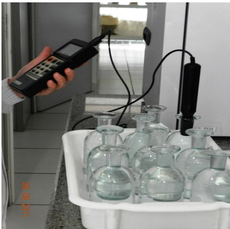
FIGURA 17- Técnica de realização de DBO em amostras de água – verificação da taxa de oxigênio dissolvido inicial.
