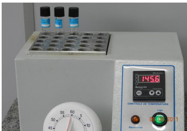
FIGURA 20- Digestor de alta temperatura para determinação de DQO
