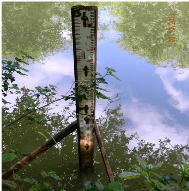
FIGURA 27- Régua de medição do nível de água da SANEPAR, no local de monitoramento à montante do perímetro urbano.
