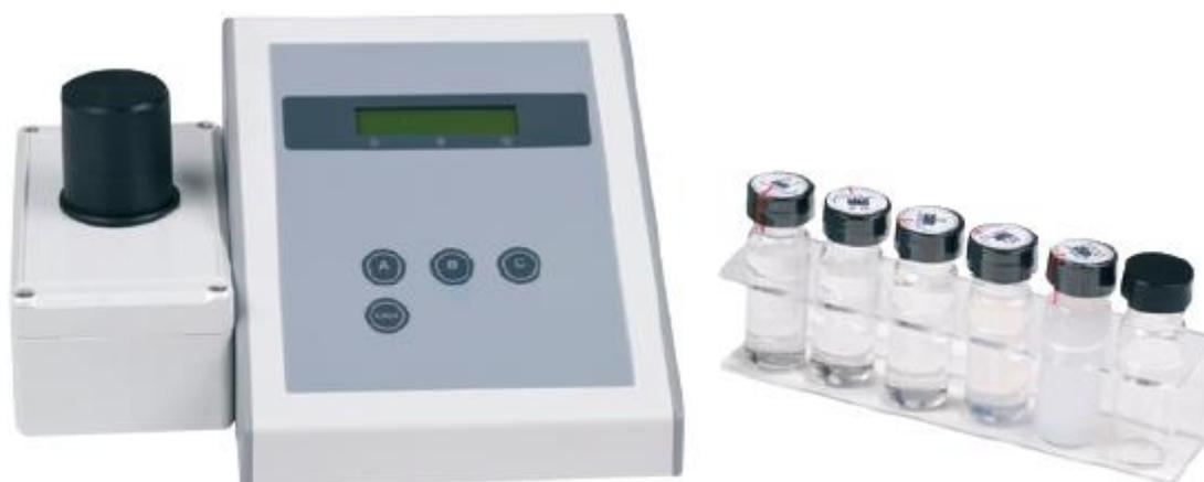
FIGURA 18- Turbidímetro TECNAL® TB1000, usado na determinação da turbidez nas amostras de água.
