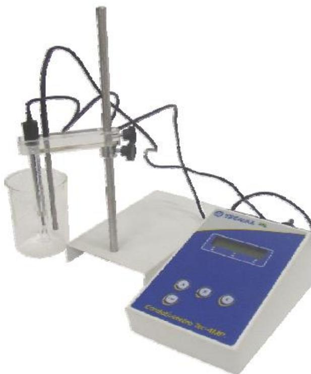
FIGURA 21- Condutivímetro TECNAL® TEC 4MP
