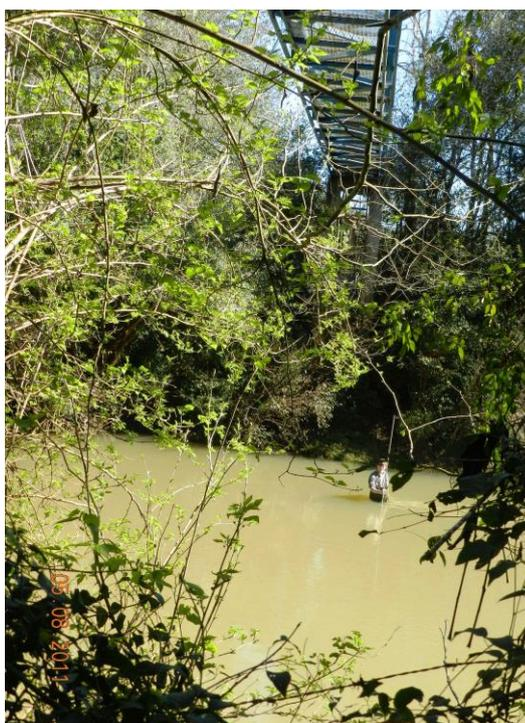
FIGURA 28-Medição da velocidade da água com molinete e coleta de amostras, com uso de macacão impermeável.
