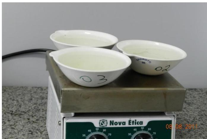
FIGURA 19- Processo de evaporação da água na determinação dos sólidos totais.
