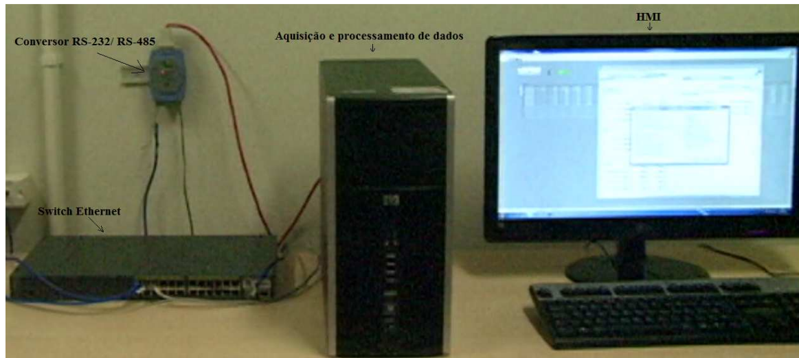
Figura 4.10. Sistema para conversão, aquisição e processamento de dados junto com uma HMI.
