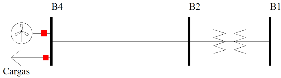
Figura 3.4: Diagrama unifilar sistema com um alimentador.
