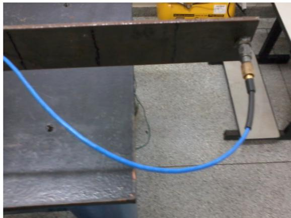
(b) Acelerômetro utilizado para a medição da resposta (saídas do sistema).
