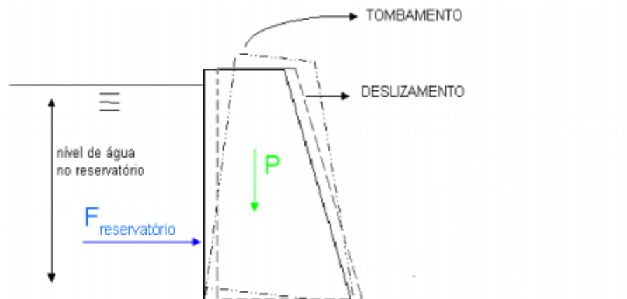
Figura 1.2 Esforços em Barragens. Fonte: Villwock (2009)
